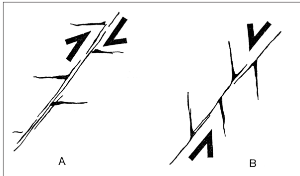
Сл.55 – Однос тензионих пукотина и трасе раседа (Димитријевић, 1978; 233) Fig.55 – Relation between tension joints and a fault (Dimitrijević, 1978; 233)
