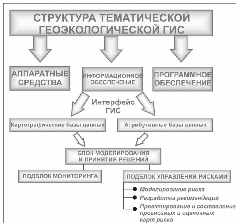
Рисунок 2 – Структура и функциональная направленность ГИС геоэкологического риск-анализа
